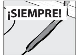
**SIEMPRE** empotre completamente los empalmes de fábrica y todo el cable calentador en mortero. **NUNCA** doble el empalme ni coloque una de sus partes en la pared o en el piso.
