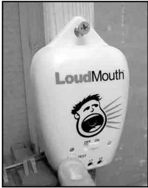
**El monitor de LoudMouth™ que se muestra a la izquierda controlará constantemente el cable de calefacción durante todo el proceso de instalación. Si el cable se corta o daña durante la instalación, este dispositivo emite una alarma. LoudMouth evitará que entierre un cable dañado debajo del concreto endurecido.**
