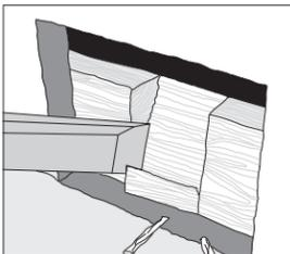
Pour les installations de mise à niveau, coupez la cloison sèche et découpez la plaque de base pour acheminer les fils vers la commande.
